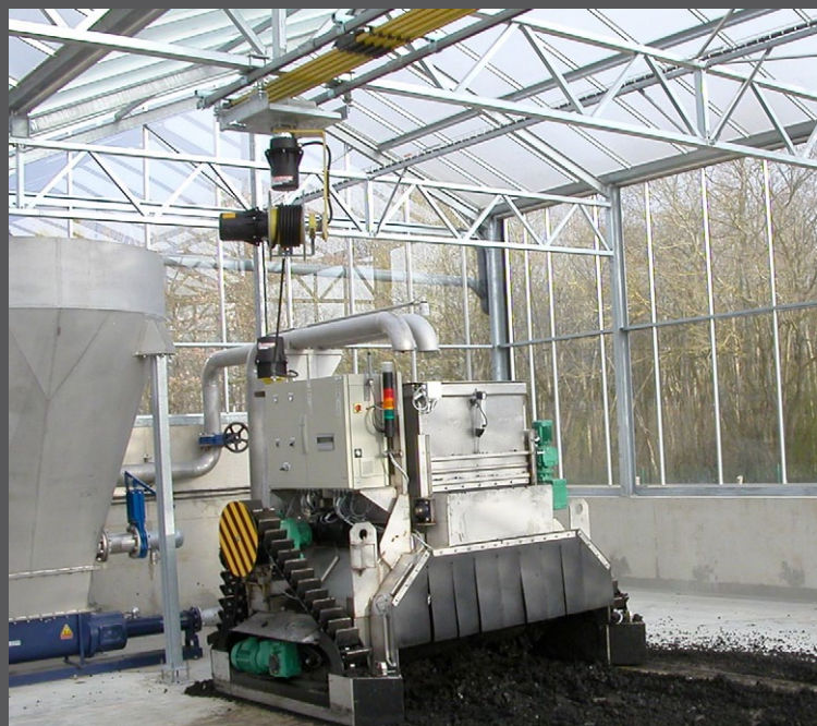
用于污泥干燥系统的、配备滑触线、弹簧卷盘及滑环组件的定制化解决方案
