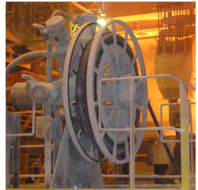
3-2-3 盘体形式是单螺旋缠绕和随机缠绕盘体的组合体。盘体的间距为3倍电缆直径，电缆排列为多层缠绕。
