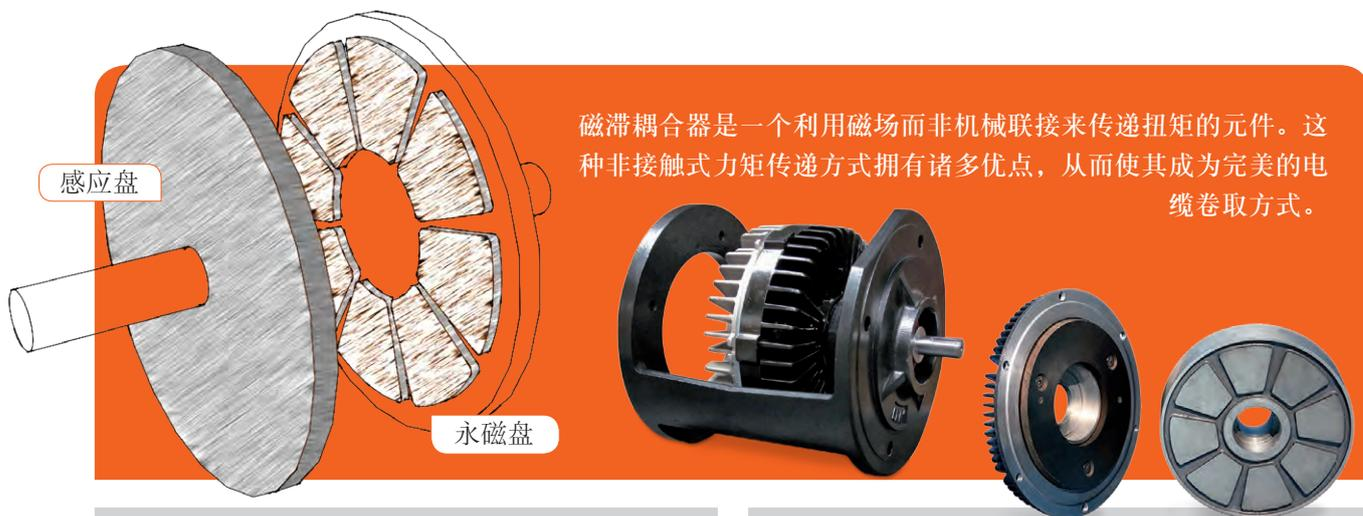
磁滞耦合器是一个利用磁场而非机械联接来传递扭矩的元件。这种非接触式力矩传递方式拥有诸多优点，从而使其成为完美的电缆卷取方式。
