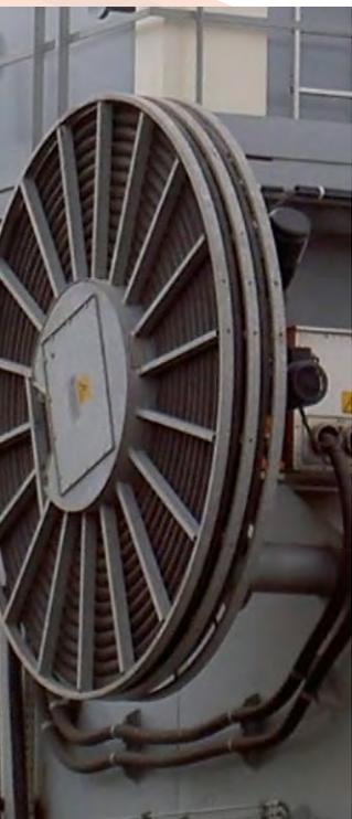
双盘单螺旋缠绕盘体可驱动两根相同的大横截面电缆
