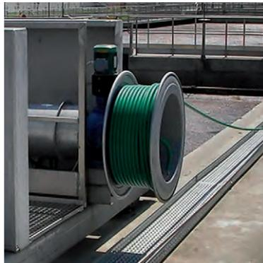
随机缠绕盘体形式特别适用于卷绕中短程的电缆/水缆。
