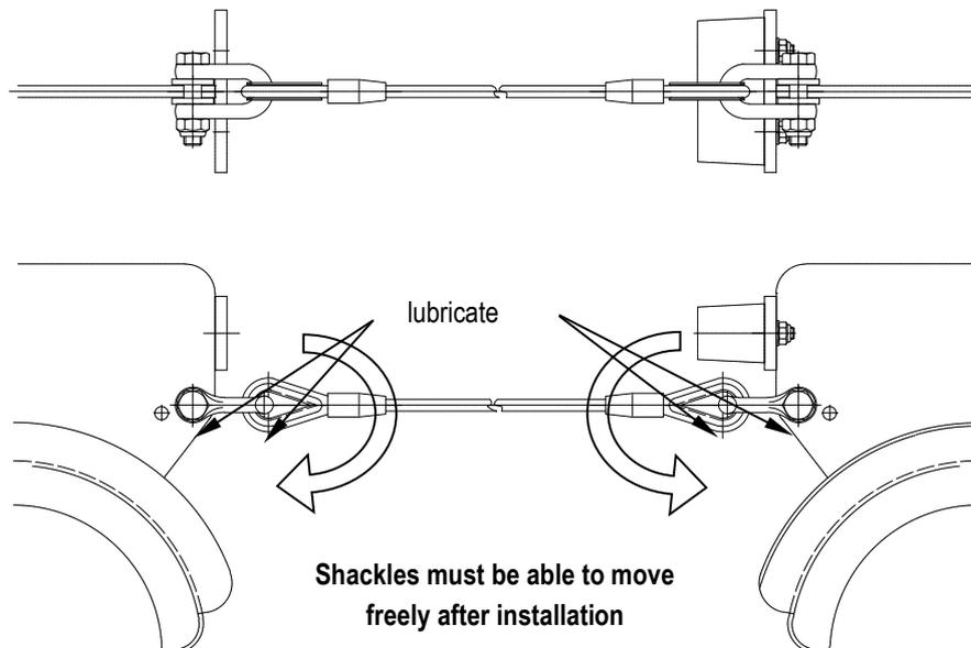
Fig. 33: Towing rope
