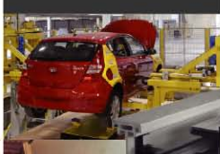
滑板输送线系统 应用IPT ® 导轨感应式移动供电
