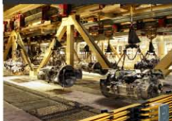
电子输送小车(EMS)系统 应用滑触线移动供电
