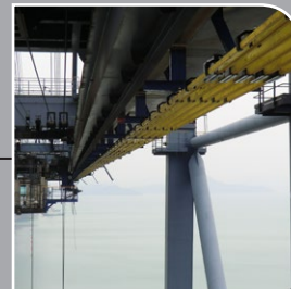
带数据传输的 滑触线系统
