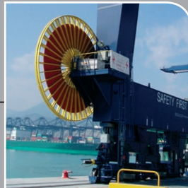
用于岸桥的 光纤电动卷盘
