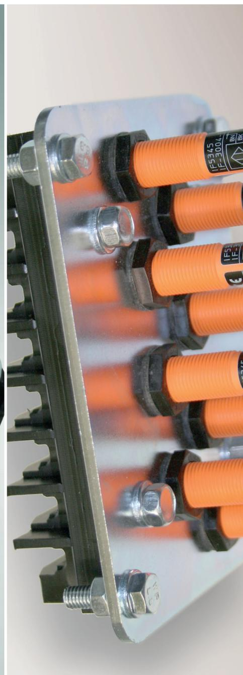
集电器碳刷磨损检测器
