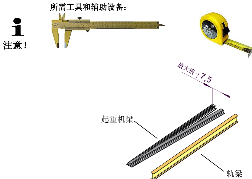
图9: 起重机梁和轨梁之间的水平对齐偏差
